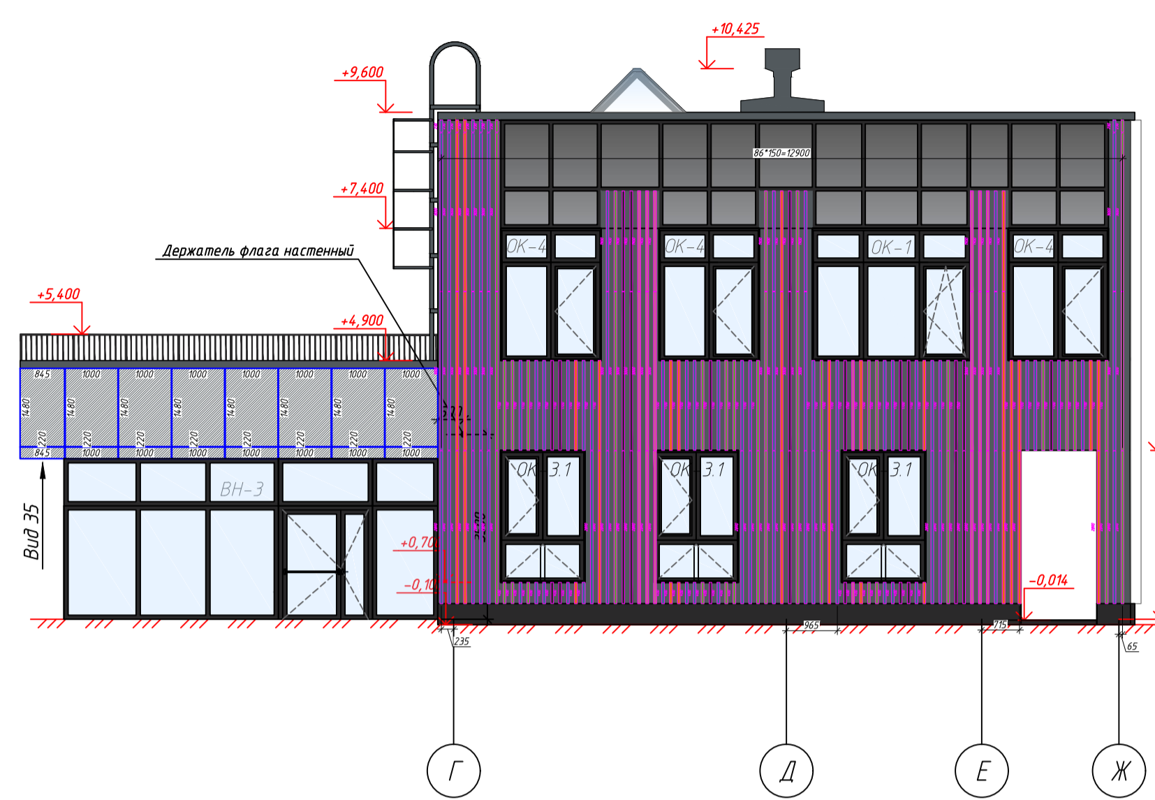
Фрагмент фасада в осях Г-Ж (Вид 16)
